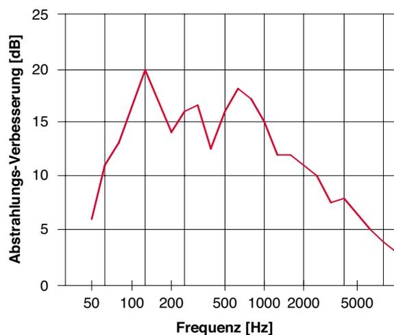
Messung mit Blech 0.8 mm und ANTIPHON Schwerfolie SF-B
