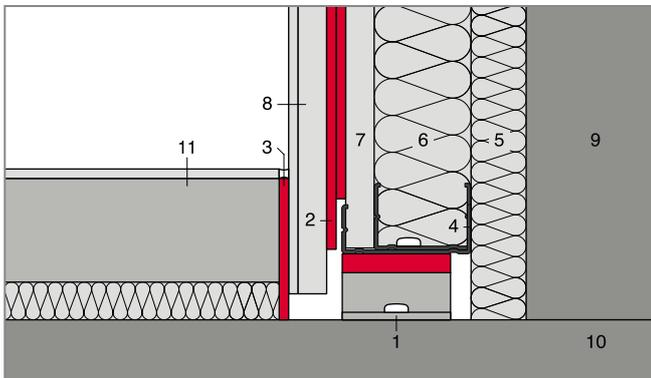
**Vorsatzschalenbefestigung am Boden**
